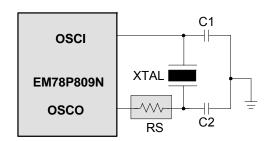
Fig. 31. Crystal/Resonator Circuit
